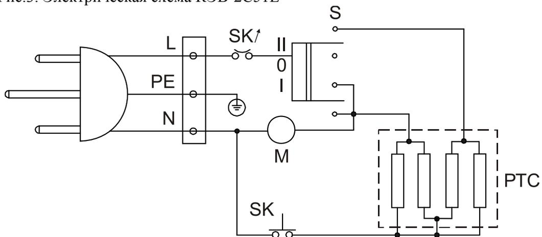
Рис.4. Электрическая схема КЭВ-3С41Е
