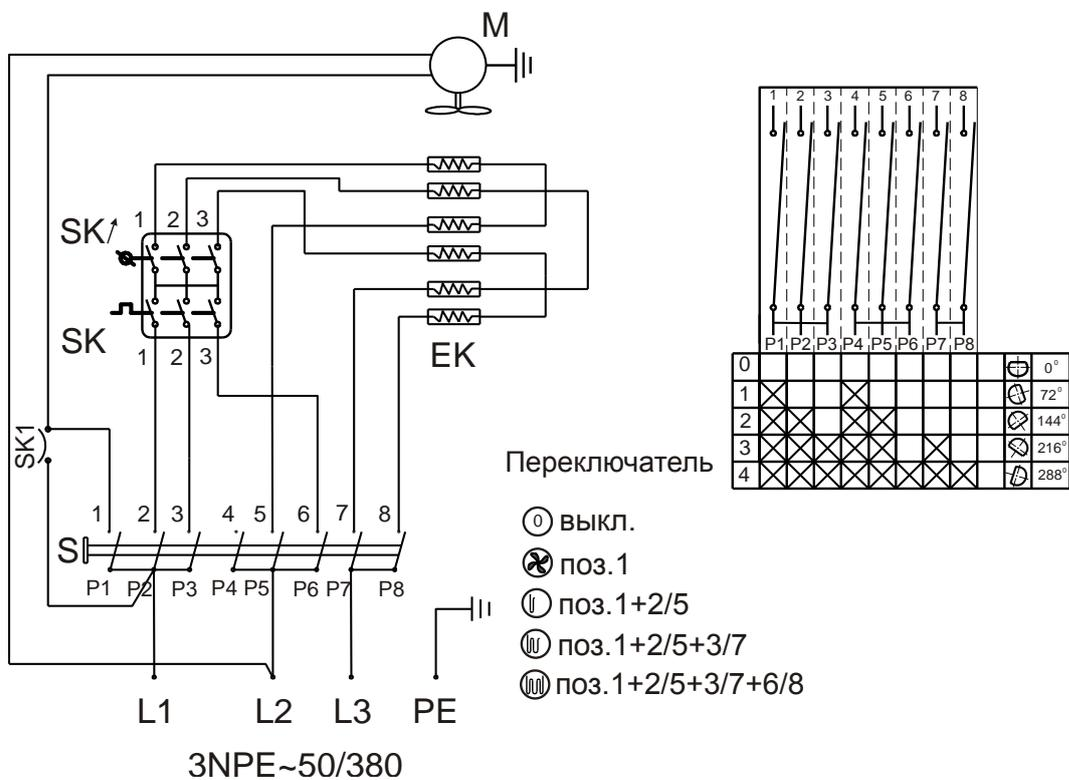
Рис 9. Электрическая схема КЭВ-18С40Е
