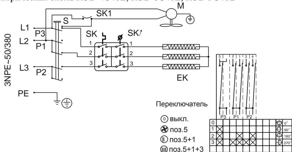
Рис.8. Электрическая схема КЭВ-12С40Е, КЭВ-15С40Е
