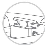
**Установка:** вставьте ось крышки в держатель под углом 20 - 30° до щелчка.
