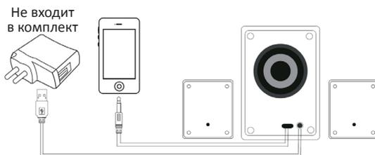
4. Подключите аудиокабель устройства к аудиоразъему источника сигнала (плеер/смартфон/планшет/ПК и т. д.), как указано на схеме ниже.
