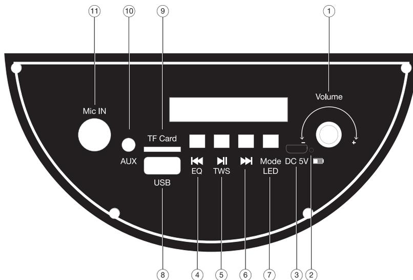
1. Регулировка громкости и включение устройства
