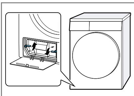
3. Снимите крышку теплообменника, потянув за ручку.
