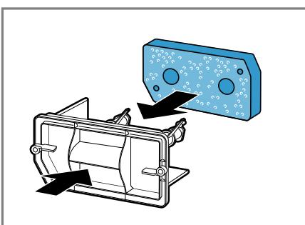
Следите за тем, чтобы после очистки фильтрующая прокладка не была повреждена/деформирована или установлена в крепление неправильным образом.
