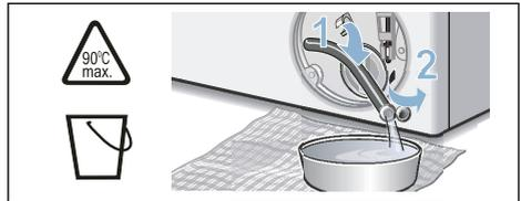
5. Осторожно отверните крышку насоса и выпустите остатки воды. Очистите внутреннюю поверхность, резьбу крышки насоса и корпус насоса. Лопастное колесо откачивающего насоса должно свободно вращаться. Установите крышку насоса на место и прикрутите её. Ручка должна находиться в вертикальном положении.
