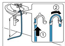
Полностью пропустите сливной шланг через и закрепите с помощью крепежного материала.
