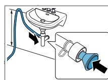
Зафиксируйте соединение хомутом (12–22 мм).
