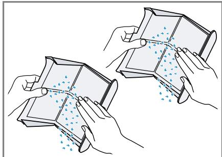
**8. Тщательно промойте обе фильтрующие сетки под теплой проточной водой и высушите их.**
