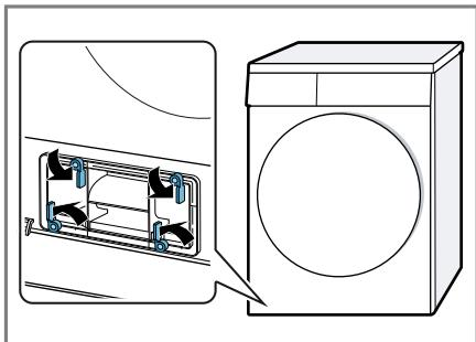
3. Снимите крышку теплообменника, потянув за ручку.
