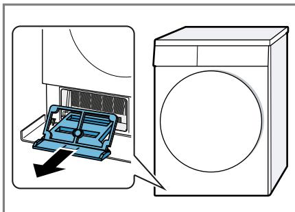
5. Промойте вставку под проточной водой и просушите.
