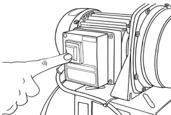
6. После удаления воздуха станция готова к работе. Насос создаст необходимое давление и наполнит гидроаккумулятор водой. При достижении установленного давления реле давления отключит насос.
