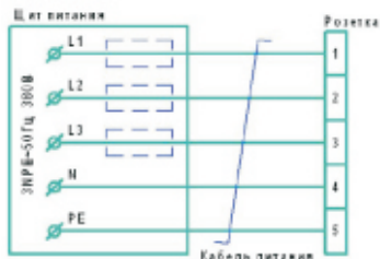
Рис. 3 Схема подключения розетки к стационарной сети
