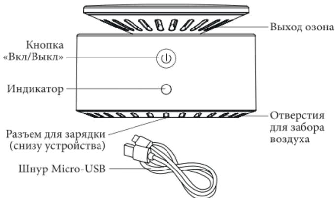
Нажав и удерживая **кнопку «Вкл/Выкл»** в течение 2 секунд, можно включить и выключить озонатор. После включения автоматически включается режим нормального озонирования.
