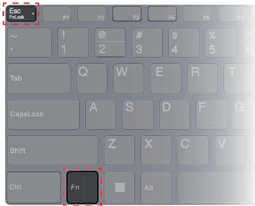
Рис. 2. Расположение клавиш FnLock и Fn
