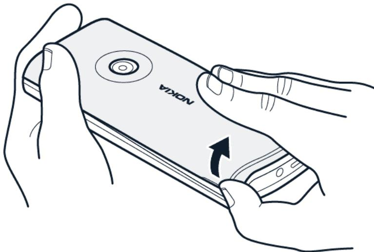
1. Вставьте ноготь в небольшую канавку сбоку телефона, поднимите и снимите крышку.
