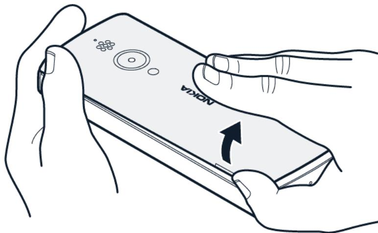
1. Вставьте ноготь в небольшую канавку сбоку телефона, поднимите и снимите крышку.
