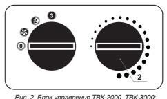
Рис. 2. Блок управления ТВК-2000, ТВК-3000: 1 – переключатель режимов; 2 – терморегулятор
