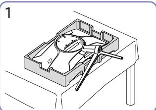
Положите на пол защитный пенопластовый материал (стиропор), входящий в комплект, и разместите на нем устройство экраном вниз, как показано на рисунке.
