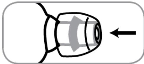
**Предупреждение.** Если шип или часть наконечника видны, значит, насадка надета неправильно. Замените насадки, если они неплотно охватывают наконечники. Чтобы обеспечить надлежащее прилегание и качество работы, используйте только насадки, поставляемые компанией Shure (за исключением насадок, специально изготовленных по форме уха).
