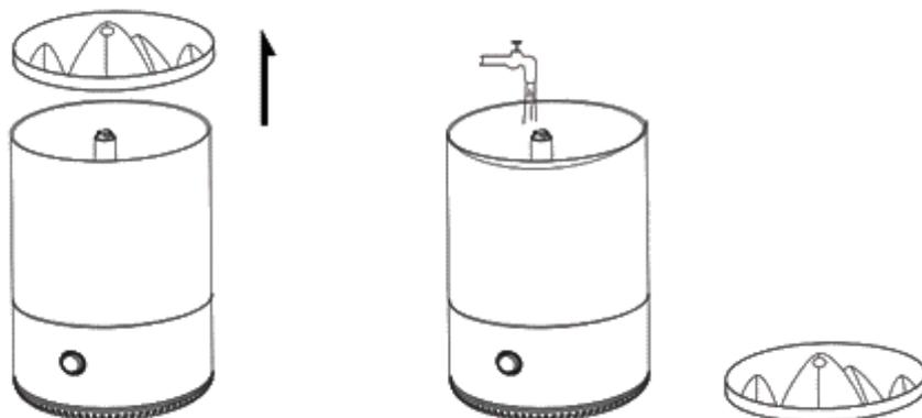
1. Установите прибор горизонтально в подходящем месте. Снимите седло форсунки и добавьте воду комнатной температуры в резервуар для воды (обратите внимание, что это не распылительный порт, «добавляющий воду»), закройте «гнездо форсунки» и подключите прибор к источнику питания 220 В, 50 Гц.
