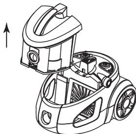
3. Извлеките фильтр из пылесборника. Промойте фильтр водой и дайте полностью высохнуть.
