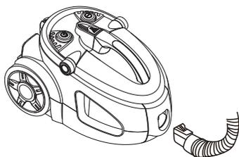
**Примечание:** чтобы извлечь гибкий шланг, сначала отключите устройство от сети, нажмите на защелку, расположенную на конце шланга, и извлеките его.
