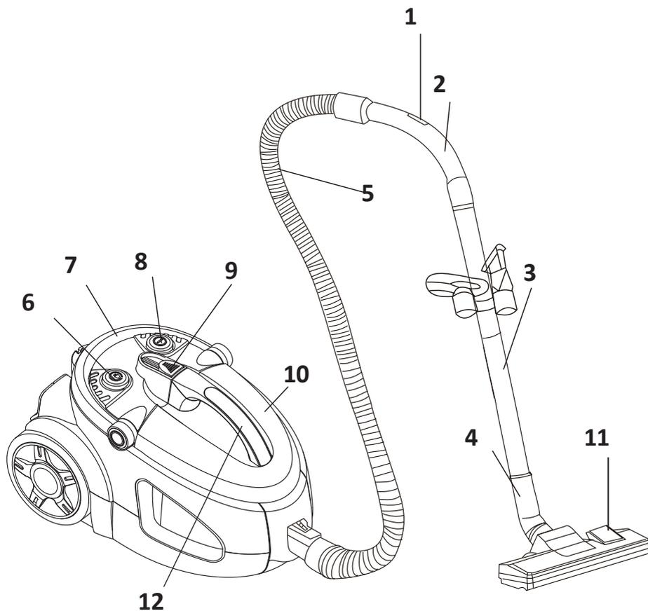
1. Регулятор мощности всасывания.
