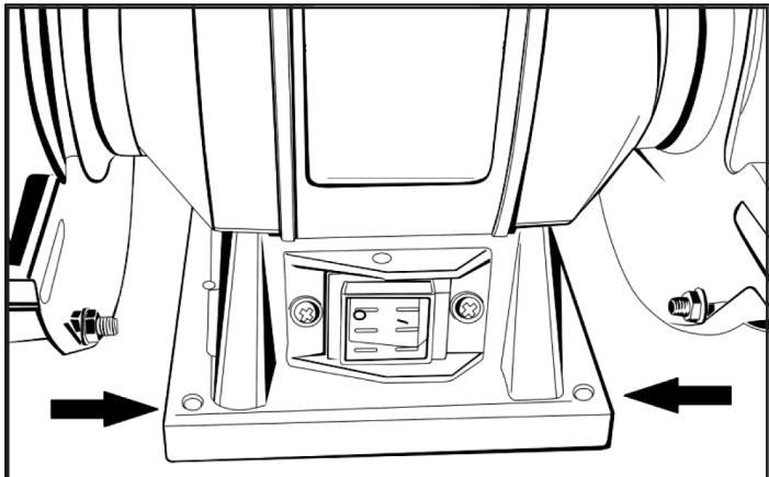
Сделайте на столе разметку под отверстия станка, просверлите их и установите станок, туго затянув винтами (не поставляются в комплекте).
