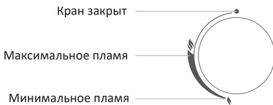
Все краны имеют фиксированное положение «малое пламя», обеспечивающее горение в экономичном режиме. Это удобно при необходимости резко убавить огонь, не выключая горелку.
