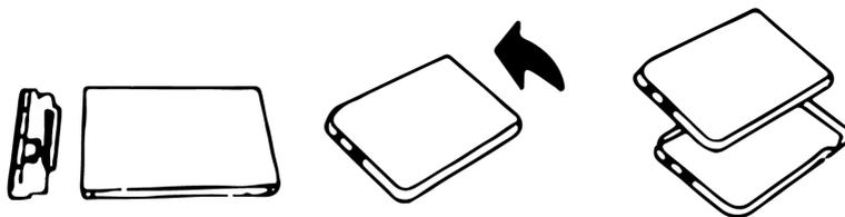
2. Вставьте жесткий диск в разъем и зафиксируйте его.
