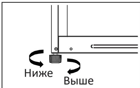
Холодильник необходимо выровнять на плоском твердом полу с помощью регулирующей ножки (для более подробной информации обратитесь к разделу «Выравнивание холодильника»).
