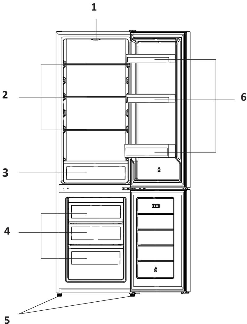
1. Терморегулятор со световым индикатором.
