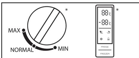
С помощью регулятора настройте рекомендуемую температуру (для более подробной информации обратитесь к разделу «Эксплуатация»).\* Вид регулятора температуры может отличаться в зависимости от модели холодильника.
