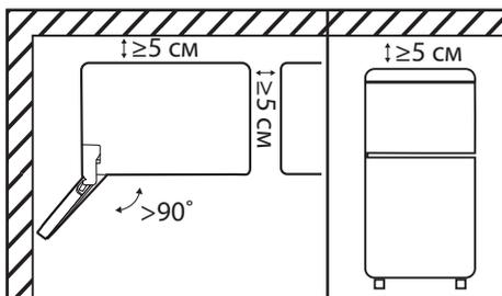
При установке холодильника боковой стороной к стене помещения предусмотрите наличие достаточного пространства для открывания дверей на угол более 90°. Сверху, с задней и боковых его сторон должно быть свободное пространство не менее 5 см (для более подробной информации обратитесь к разделу «Установка»).
