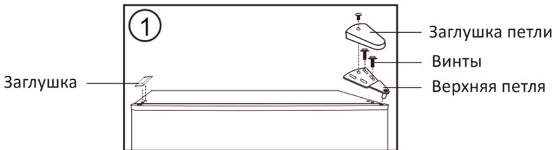
2. Снимите дверь холодильной камеры. Переставьте заглушку с левой стороны двери на правую. Снимите дверь холодильной камеры. Переставьте заглушку с левой стороны двери на правую.
