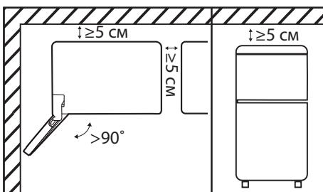
При установке холодильника боковой стороной к стене помещения предусмотрите наличие достаточного пространства для открывания дверей на угол более 90°. Сверху, с задней и боковых его сторон должно быть свободное пространство не менее 5 см (для более подробной информации обратитесь к разделу «Установка»).
