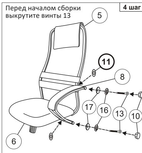
**Примечание:** шаг 1 — снять защитный колпачок с газлифта, в случае его налипания. В шаге 2 сначала закрутить винты I, не затягивая их до конца. Далее закрутить винты II до полной фиксации. После этого винты I закрутить до полной фиксации. Шаг 4–5: Подложить металлические шайбы (позиция №11) под подлокотники. Винты 13 вкручены в каркас спинки.
