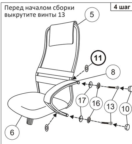
**Примечание:** шаг 1 — снять защитный колпачок с газлифта, в случае его наличия. В шаге 2 сначала закрутить винты I, не затягивая их до конца. Далее закрутить винты II до полной фиксации. После этого винты I закрутить до полной фиксации. Шаг 4–5: Подложить металлические шайбы (позиция №11) под подлокотники. Винты 13 вкручены в каркас спинки.
