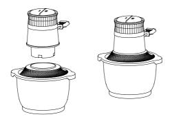
**Примечание:** убедитесь, что моторный блок установлен корректно. Лепестки лезвий должны точно входить в моторный блок.
