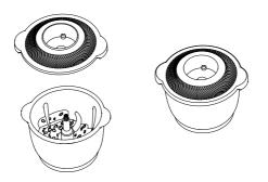
5. Зафиксируйте моторный блок на защитной крышке измельчителя.
