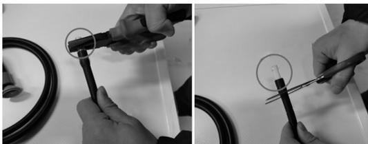
3. Потяните за трубку слива, расположенную в задней части сушильной машины, чтобы отсоединить ее. Затем зафиксируйте ее на креплении слева.
