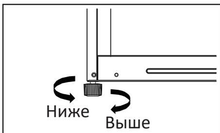
Морозильный шкаф необходимо выровнять на плоском твердом полу с помощью регулирующей ножки (для более подробной информации обратитесь к разделу «Выравнивание морозильного шкафа»).
