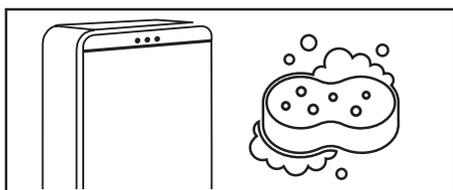
Тщательно вымойте морозильный шкаф. Не следует смывать силиконовую смазку, нанесенную на дверной уплотнитель и фронтальную часть корпуса со стороны дверных петель.
