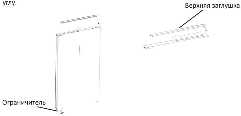
5. Возьмите верхнюю дверную петлю для левой стороны из комплекта поставки, установите на устройство. Соедините провода, установите накладку для дверной петли.
