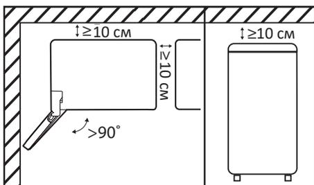
При установке морозильного шкафа боковой стороной к стене помещения предусмотрите наличие достаточного пространства для открывания дверей на угол более 90 градусов. Сверху, с задней и боковых его сторон должно быть свободное пространство не менее 10 см (для более подробной информации обратитесь к разделу «Установка»).
