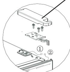
3. Отсоедините конструкцию правой нижней петли (штифт, регулируемую ножку и петлю). Разберите конструкцию и установите штифт и регулируемую ножку с другой стороны петли, затем закрепите ее на противоположной стороне устройства.
