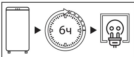
После транспортировки не подключайте морозильный шкаф к сети в течение 6 часов.
