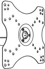
**2** Просверлите отверстия  $\varnothing 10$  мм на глубину 60 мм, предварительно высверлив отверстия  $\varnothing 4$  мм.
