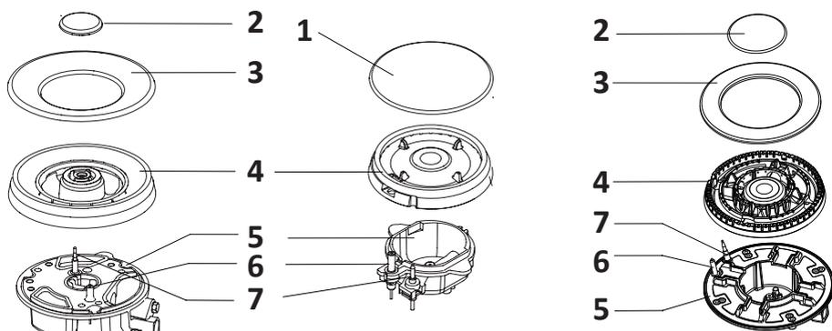
1. Установите рассекатель горелки (4) на чашу горелки (5). Убедитесь, что рассекатель горелки установлен верно по отношению к свече зажигания (6) и термопаре (7).
