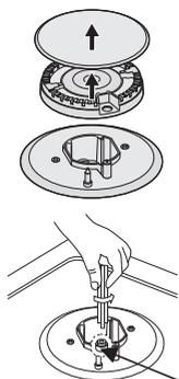
1. Снимите решетку, крышку горелки и рассекатель.
