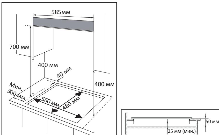
Размеры указаны с учетом расстояния от варочной поверхности до кухонной вытяжки.
