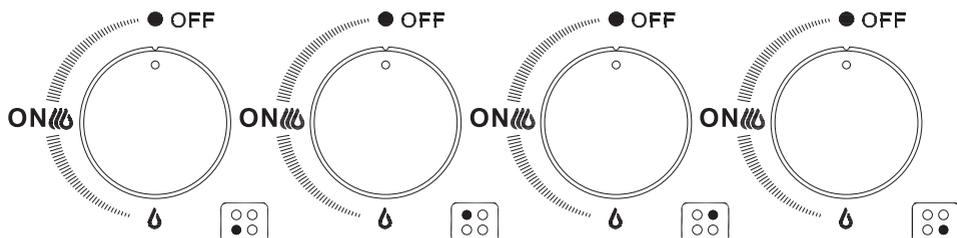
1. Нажмите регулятор выбранной горелки и поверните его против часовой стрелки до максимального уровня мощности. При нажатом регуляторе осуществляется подача газа и зажигается искровой разряд (вы услышите щелчок сработавшего электрического поджига).
