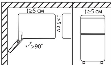
При установке холодильника боковой стороной к стене помещения предусмотрите наличие достаточного пространства для открывания дверей на угол более 90°. Сверху, с задней и боковых его сторон должно быть свободное пространство не менее 5 см (для более подробной информации обратитесь к разделу «Рекомендации по установке»).
