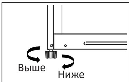
Холодильник необходимо выровнять на плоском твердом полу с помощью регулируемой ножки (для более подробной информации обратитесь к разделу «Выравнивание холодильника»).
