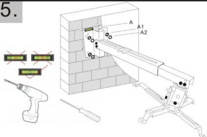
1. Просверлите 4 отверстия (10 x 50 мм).
