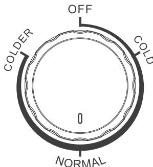
Поворотный регулятор выбора температуры расположен внутри холодильника.
