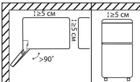
При установке холодильника боковой стороной к стене помещения предусмотрите наличие достаточного пространства для открывания дверей на угол более 90 градусов. Сверху, с задней и боковых его сторон должно быть свободное пространство не менее 5 см (для более подробной информации обратитесь к разделу «Установка»).
