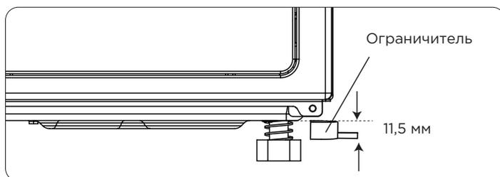
5. Выдвиньте выдвигающую часть соединительного элемента наполовину вперед.
