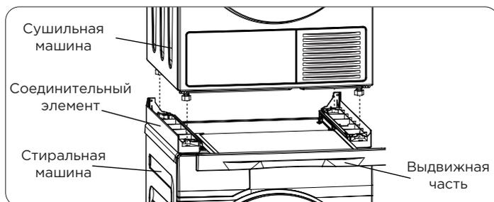
7. Возьмите два винта, которые Вы ранее сняли с задней нижней части сушильной машины, и закрепите их обратно, пропустив через специальные отверстия для крепежа в соединительном элементе, скрепив таким образом заднюю часть сушильной машины с соединительным элементом.
