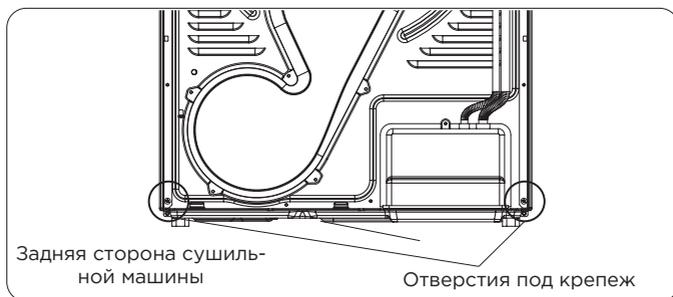
4. Отрегулируйте высоту ножек сушильной машины таким образом, чтобы можно было вставить ограничитель высоты (зазор должен составлять примерно 11,5 мм).
