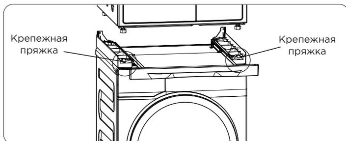
9. Задвиньте выдвижную часть соединительного элемента на место. Установка завершена.
