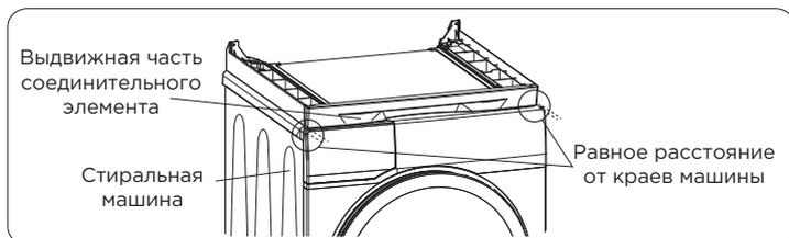
2. Закрепите элемент на верхней крышке стиральной машины с помощью четырех винтов.
