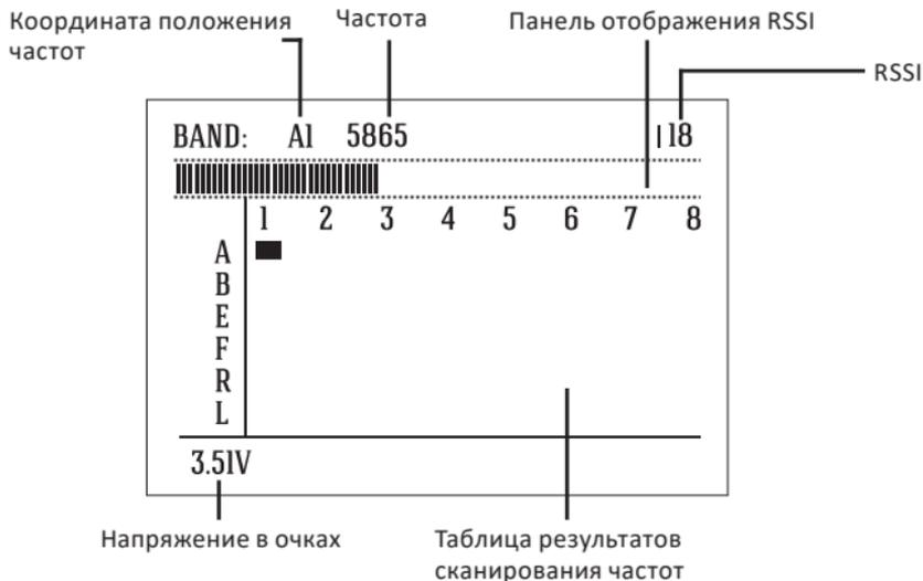
Войдя в интерфейс сканирования частот, нажмите и удерживайте кнопку поиска в течение 1 секунды, и результат развертки отобразится через 3 секунды. Различные цвета на экране показывают текущее состояние каждой частоты:
