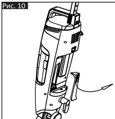
3. После очистки установите крышку вентиляционного канал, фильтр и бак для жидкости обратно.
