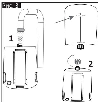
3. Закрутите крышку бака для жидкости и установите его на место до фиксации, как это показано на схеме ниже.
