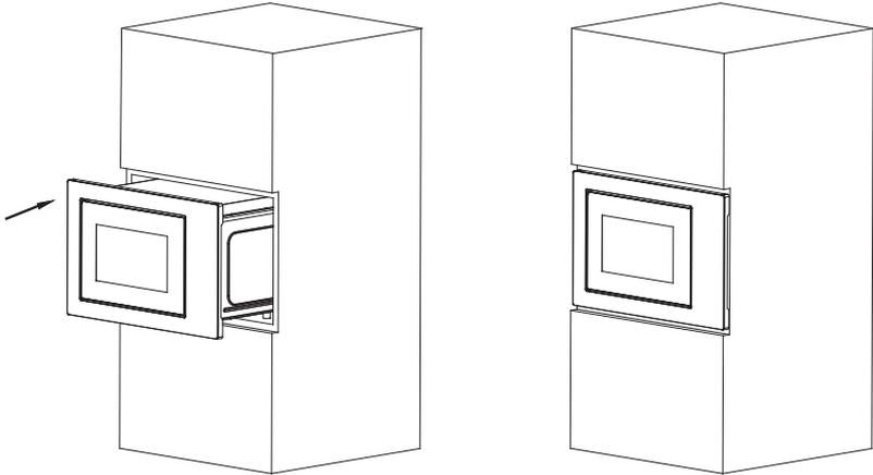
2. Отрегулируйте положение устройства по центру шкафа и зафиксируйте печь с помощью 4 винтов.
