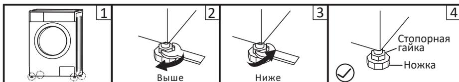
1. Ослабьте стопорную гайку гаечным ключом и поворачивайте ножку вручную до полного контакта с полом. Прижмите ножку одной рукой, а другой затяните гайку.
