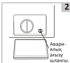
Төтенше су төгетін шлангтың бітегішін 90° бұраңыз және шлангты шығарыңыз. Бітегішті шешіңіз.
