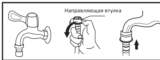
Специальный кран для стиральной машины
