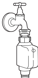
ПОДКЛЮЧЕНИЕ ЧЕРЕЗ ПРЕДОХРАНИТЕЛЬНЫЙ КЛАПАН
