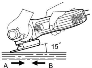
Выполнение работ с абразивным отрезным кругом или алмазным кругом. При использовании абразивного отрезного круга или алмазного круга может применяться только специальный защитный кожух, предназначенный для отрезных кругов.
