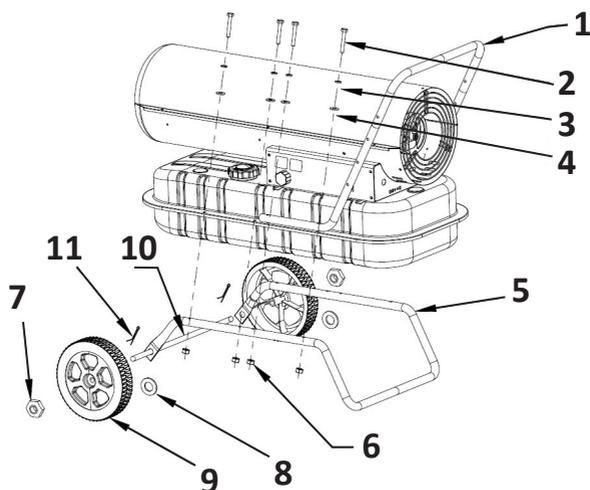
1. Вставьте **вал колеса (10)** в соответствующее отверстие **несущей рамы (5)**, вставьте **шплинт (11)** в соответствующие отверстия; установите **плоскую шайбу (8)** с двух сторон вала, надвиньте **колесо (9)** на **вал колеса (10)**, закрепите **гайку (7)**, чтобы закрепить колесо на валу.
