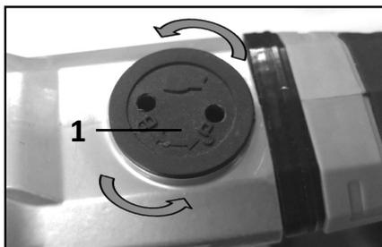
1. Крышка смазочного окна редуктора.
