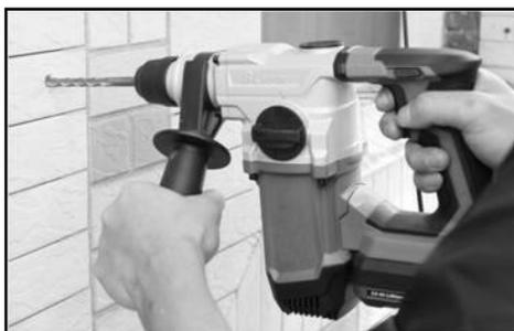
**Примечание:** при работе с инструментом без нагрузки может наблюдаться эксцентричность хвостовика бура при вращении. Инструмент осуществляет автоматическую центровку в ходе эксплуатации. Это не влияет на точность сверления.
