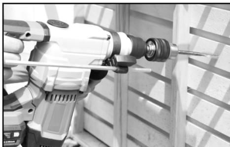
Поверните переключатель режима работы на
