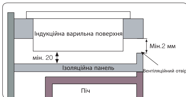
Встановлення варильної поверхні_19
