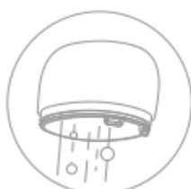
После использования нажмите нижнюю кнопку резервуара для воды и аккуратно переместите его вниз, если в резервуаре для воды осталась вода, слейте ее. Откройте крышку резервуара для воды и слейте всю оставшуюся воду из него.
