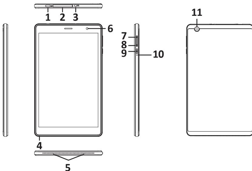
1. Разъем USB Type-C (для зарядки, подключения наушников и синхронизации с ПК).
