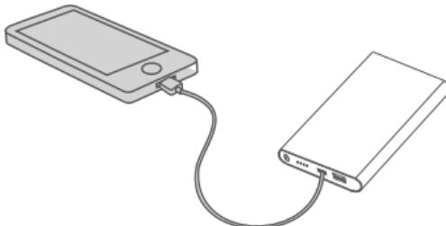
**Примечание:** аккумулятор имеет функцию сквозного заряда, поэтому Вы можете заряжать ПА и подключенные к нему устройства одновременно.
