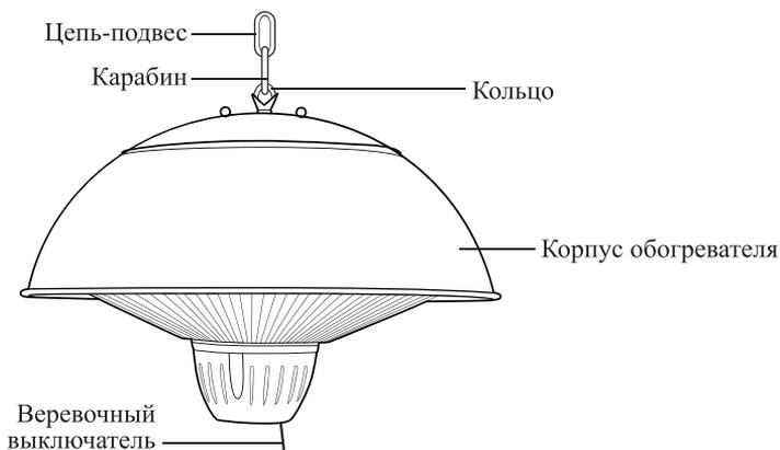
Чтобы включить устройство, необходимо потянуть за **веревочный выключатель**. У обогревателя один режим работы. Если потянуть за веревочный выключатель второй раз, устройство выключится.
